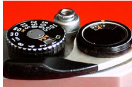
Palanca de arrastre, regulador de velocidad de obturación y botón de disparo
